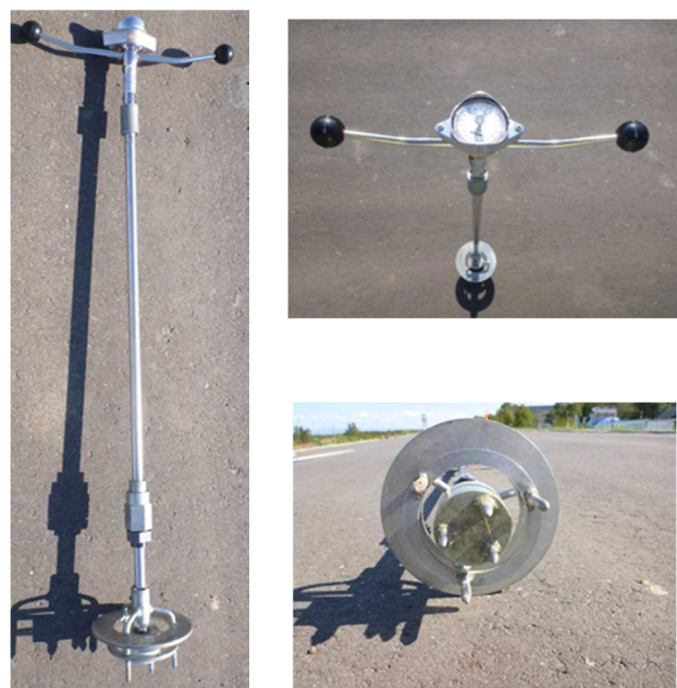
写真-2 根系強度計
