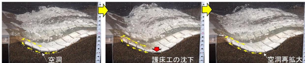
図-3 簡易水理模型実験で確認した吸出し現象
