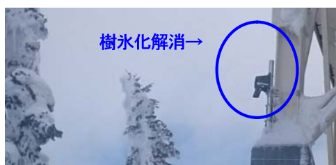
図-5 積雪センサーの樹氷化解消状況（3月上旬）
