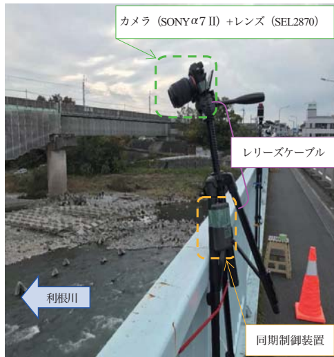
図-1 近接写真測量の計測状況
