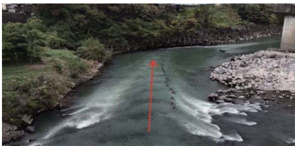
図-4 計測位置の流況 (83 秒間の 2 秒毎の多重露光撮影)
