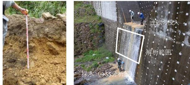
図-4 斜面土砂を用いた溪流実験の状況
