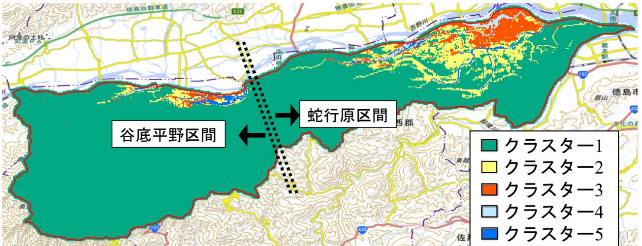
図-6：計算対象領域のハザードカーブのクラスタリング結果（クラスタ数5の例）
