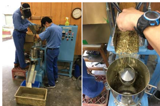
図-4 ペレット製造機による堤防刈草のペレット化
