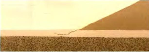
図-5 領域Ⅱを巻き込み堤体のすべり崩壊 (CASE4)
