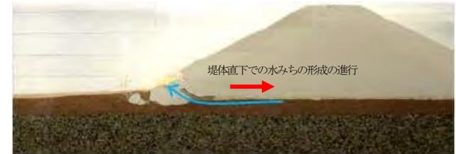
図-4 堤体直下に形成される水みち (CASE5)
