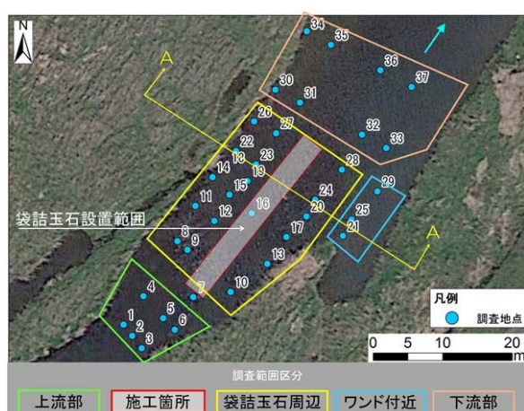
図-5 試験施工区間およびモニタリング調査地点
