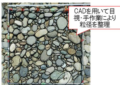
図-2 河床表面画像解析（面積百分率による粒度分布）
