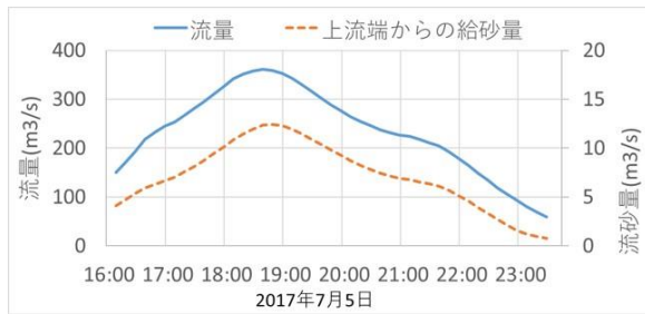
図-2 赤谷川における上流端で与えた流量ハイドログラフ及び上流端から供給した浮遊砂
