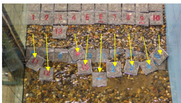
図-14 下流ふとんかごのみ移動するケース ( 280\text{cm}^3/\text{s}/\text{cm} ( 2.5\text{m}^3/\text{s}/\text{m} ))
