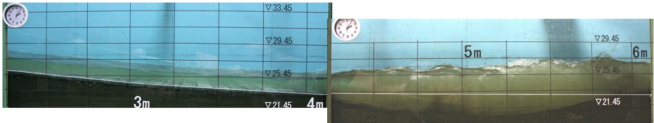
図-9 床止め下流端の跳水の状況（下流水位17.5cm）
