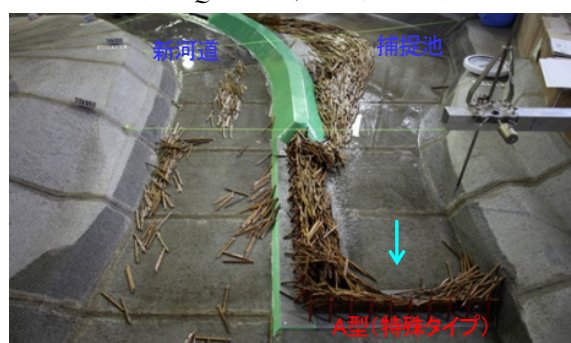
図-13 実験終了時の流木捕捉工周辺の流木堆積状況
