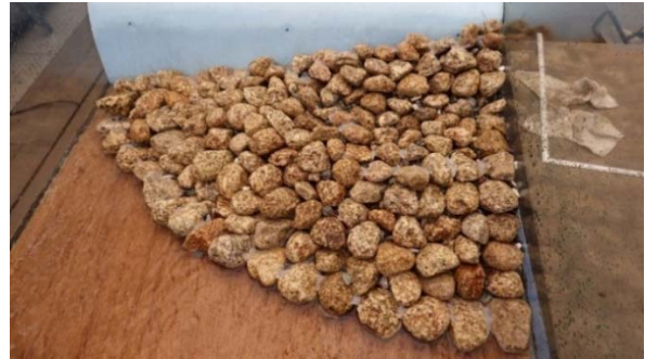
写真-14 10分の1スケールの石組み模型（写真下が下流）
