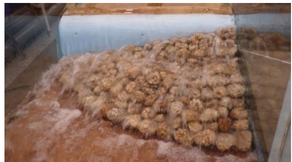
写真-16 越流水深が44cm（原型換算数値）となる流況
