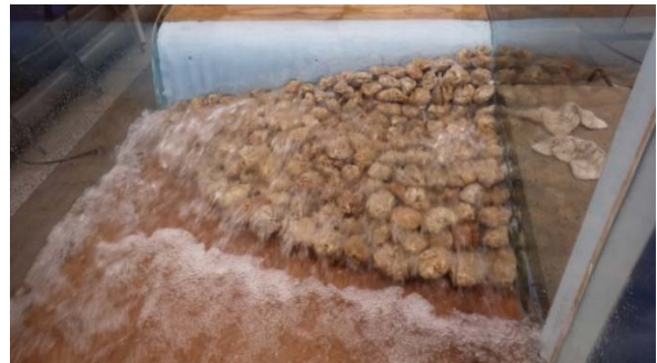
写真-17 越流水深が約60cm（原型換算数値）となる流況
