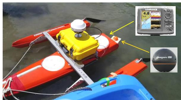
図-1 GPS測深機とDeeperによる地形計測状況
