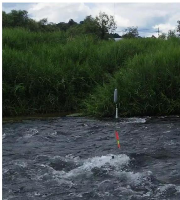
写真-2 佐波川St.1 (流速1.46m/s) における採水の様子
