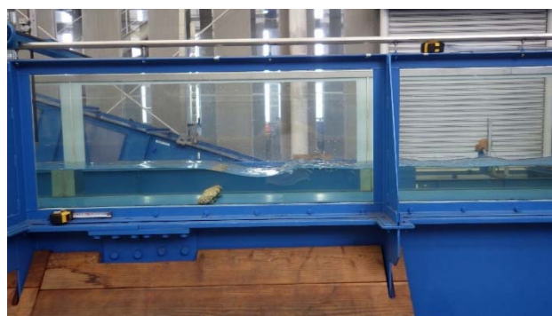
写真-3 水路中に横断方向に石組みした石を設置した状態
