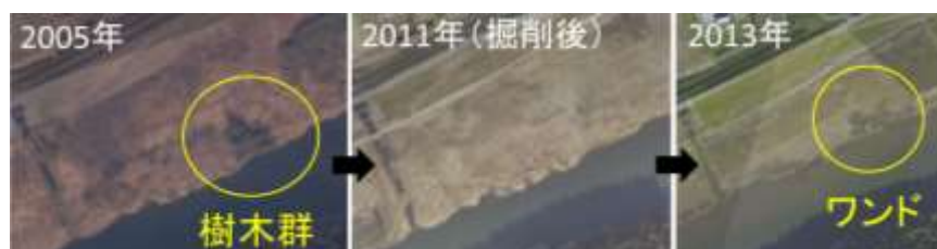
写真-2 W1形成箇所の掘削前後の様子（空中写真：国土交通省菊池川河川事務所撮影）
