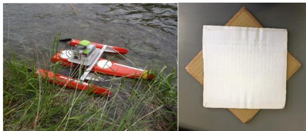
図-4 ADCPを搭載したボート
