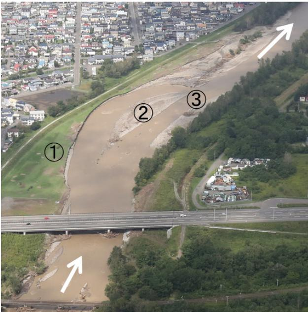
図-1 H28年台風10号による美生川下流区間での高水敷侵食被災（国土地理院撮影写真に加筆）
