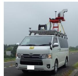
図-6 計測に使用したMMSの概観
