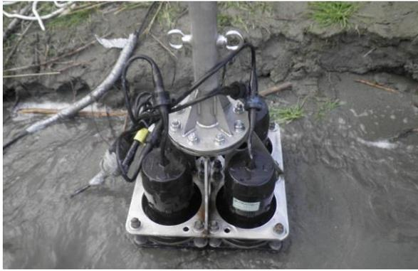
図-5 サブボトムプロファイラー(低周波タイプ4素子使用)
