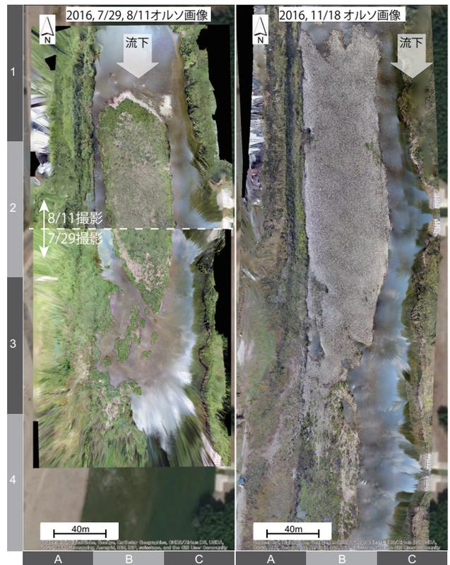
図-5 庄内川 28km 右岸の堆積域を対象とした 2016年7月29日、8月11日と11月18日の DSM オルソ画像
