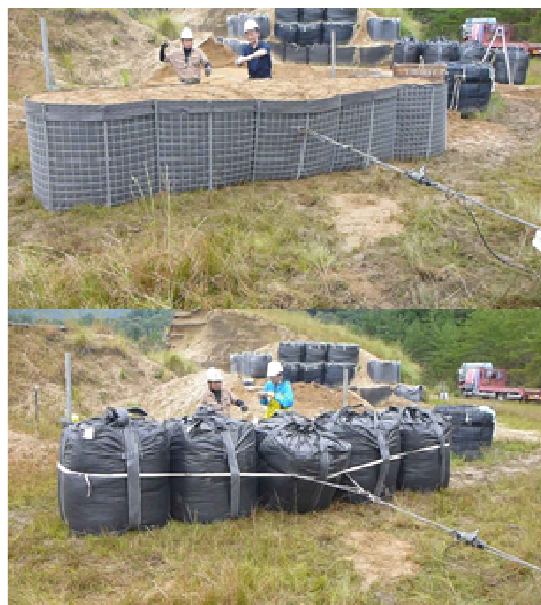
図-7 一体性検証実験の状況（上；連続箱型鋼製枠、下；大型土のう（結束有））
