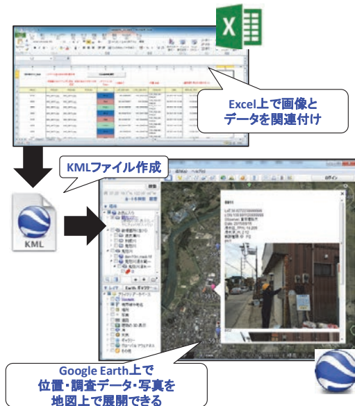
図-4 ExcelVBAを用いた位置・調査・写真データの結合 ツールとGoogleEarthを用いた地図上での展開
