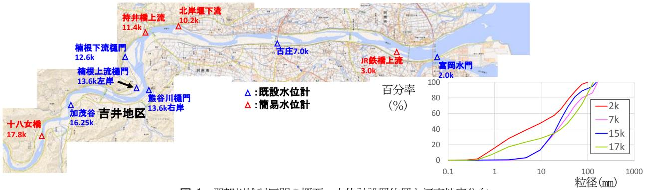
図-1 那賀川検討区間の概要、水位計設置位置と河床粒度分布
