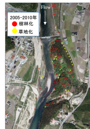
図-6 (a) 鈴屋堰、(b) 奈美堰周辺の樹林化・草地化の傾向 (背景写真:2010年4月に撮影)
