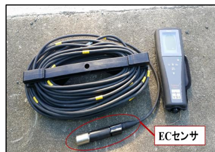
図 - 3 電気伝導率計(YSI Pro30)
