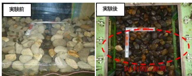
写真-1 通水前後の欠落部の状況
