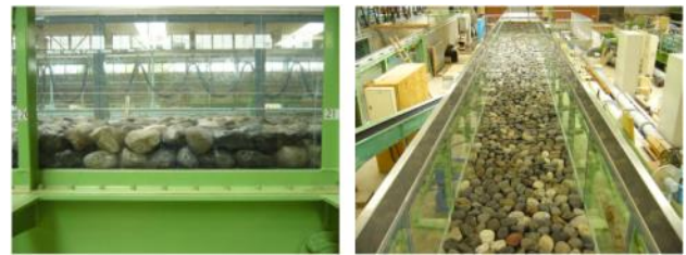
写真-1 実験水路内の礫設置状況
