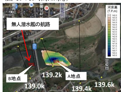
図-14 RCボートによる河床高調査結果と無次元潜水艦の調査測線
