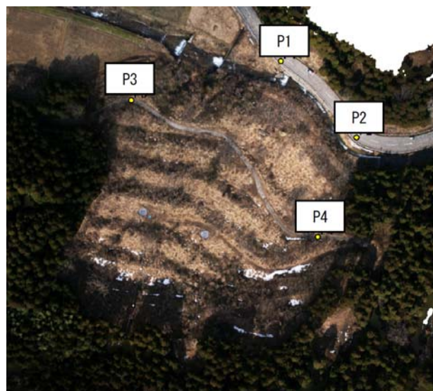
図-2 平面制御における基準点測量の位置
