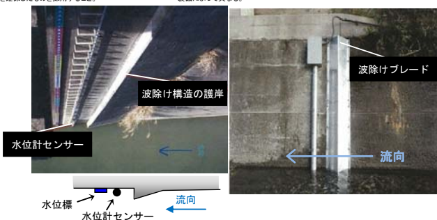
図-5 波・ゴミ除け構造護岸(左)と波除けブレード(右)
