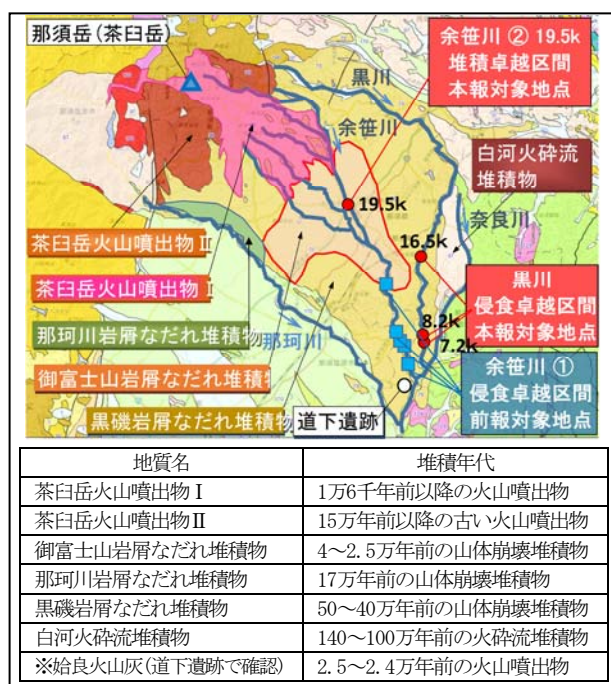
図-1 余笹川及び黒川の調査地点位置図及び表層地質平面図 (独)産業技術総合研究所シームレス地質図に加筆)
