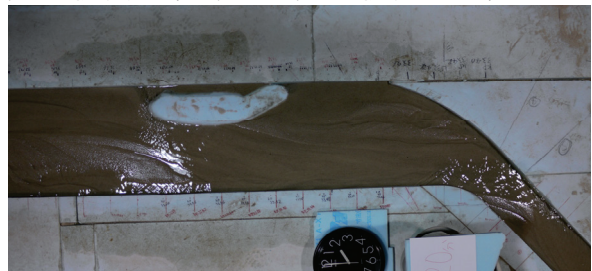
写真-7 原型流量 Q_P=35(\text{m}^3/\text{s}) の t=120 分後の状況（左：砂州が移動する場合，右：砂州が移動しない場合）
