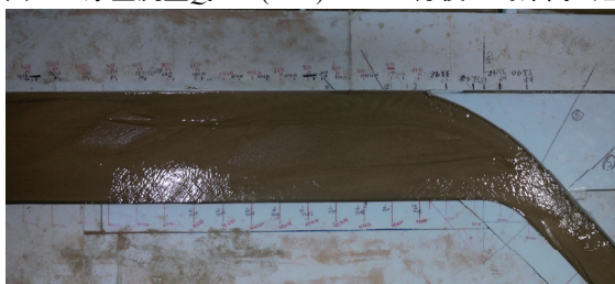
写真-8 原型流量 Q_P=40(\text{m}^3/\text{s}) の t=120 分後の状況（左：砂州が移動する場合，右：砂州が移動しない場合）
