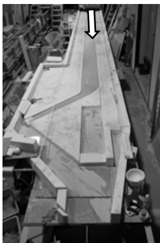
写真-4 歪模型水路の全体
