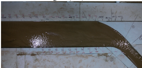
写真-7 原型流量 Q_P=35(\text{m}^3/\text{s}) の t=120 分後の状況（左：砂州が移動する場合，右：砂州が移動しない場合）
