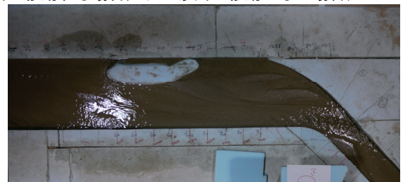
写真-8 原型流量 Q_P=40(\text{m}^3/\text{s}) の t=120 分後の状況（左：砂州が移動する場合，右：砂州が移動しない場合）
