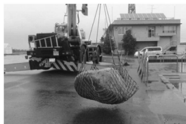
図-5 自然石+袋詰めネットの比重測定
