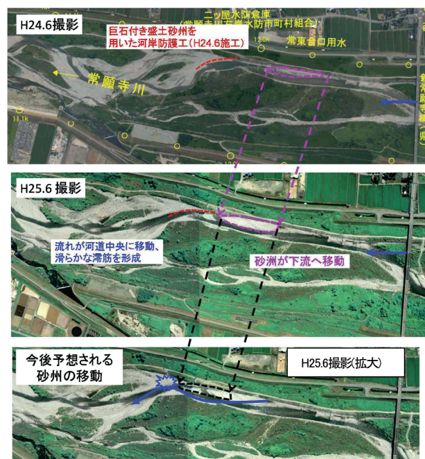
図-13 本工法設置以降の砂州の移動状況
