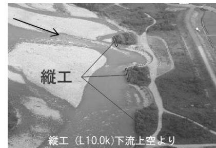
図-6 平成17年洪水による縦工間の洗掘状況 3)
