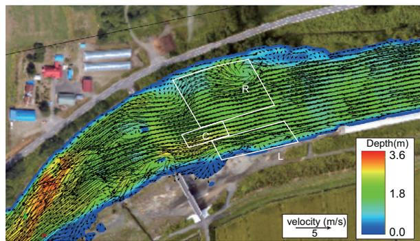
図-11 計算:流速ベクトルと水深の瞬間値, 流量370.9m<sup>3</sup>/s
