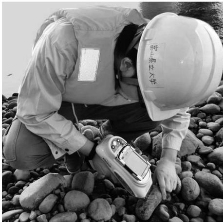
写真-1 蛍光X線分析装置を利用した現場分析風景。
