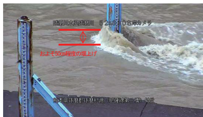
図-8 水位標(H鋼) 全面堰上げ映像（渡観測所）
