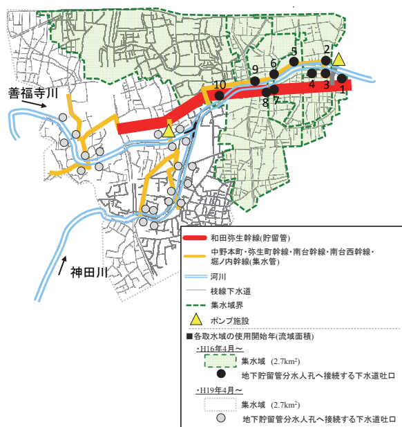
図-8 和田弥生幹線の集水域と分水人孔の設置位置 9)
