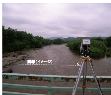
図-4 電波式流速計による計測の様子
