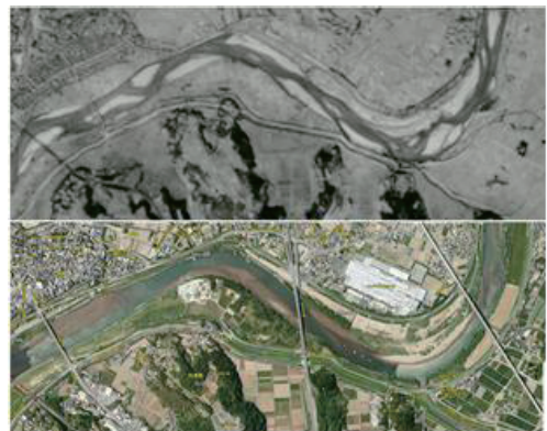
写真-1 複列砂州から単列砂州への移行 上：1947年、下：2009年（菊池川河川事務所撮影）
