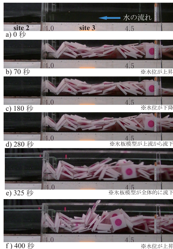
図-11 アイスジャム発生時の側面の状況 (実験ケース : 12)
