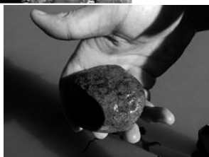
図-8 ICタグ付き礫の確認調査 と発見したICタグ付き礫
