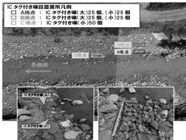
図-5 ICタグ付き礫の敷設状況
