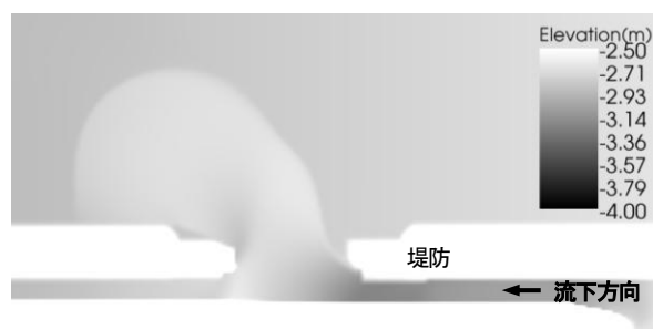
図-9 数値計算結果（最終形状、移動床）
