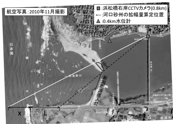
図-3 洪水時における右岸河口砂州拡幅量の算定
