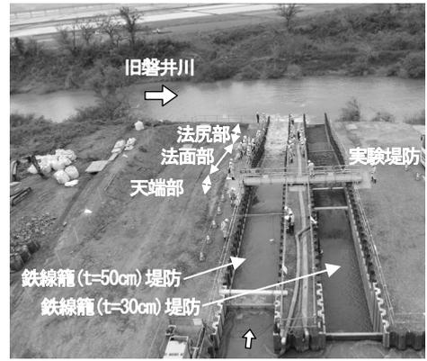
写真-1 実験施設 (堤防部) 全景
