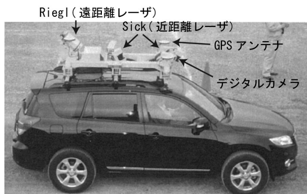
図-1 計測に使用したMMS車両 (垂直照射型)
